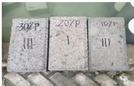
Gambar 6. Paving Block Menggunakan Limbah Plastik PP
