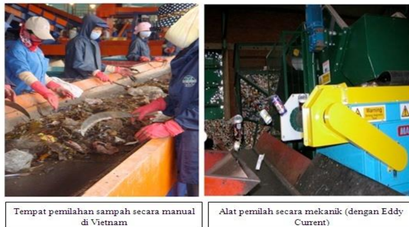
Gambar 1. Tempat Pemilahan Sampah secara Manual dan Alat Pemilah Mekanik (European Union, 2009)
