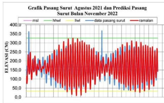
Gambar 72. Grafik Pasang Surut Agustus 2021 dan Prediksi Pasang Surut pada November 2022 di Pantai Tanjung Medang
