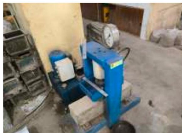
Gambar 2. Foto pelaksanaan uji kuat tarik lentur menggunakan benda uji berbentuk balok.
