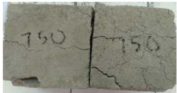
**Gambar 8. Furnace dengan suhu 500°C**
