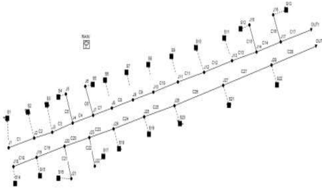
Gambar 6. Skema Jaringan Aliran Drainase Kawasan Dorak
