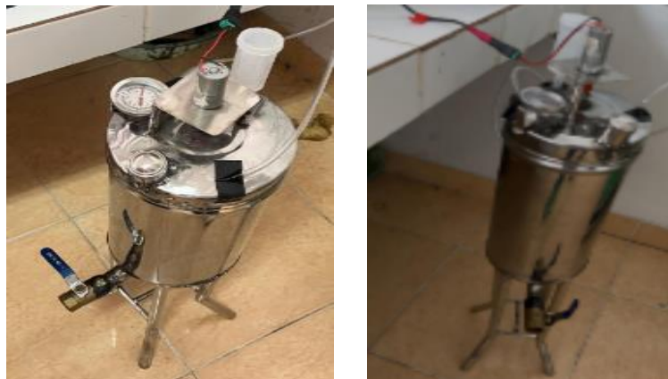
Gambar 2. Hasil rancang bangun fermentor
