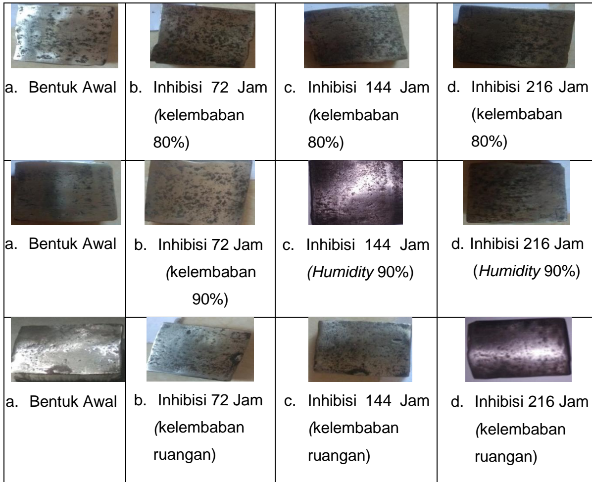
Gambar 4. Morfologi Sampel Tubing Dengan Coating Inhibitor Pada Kelembaban 80%, 90% dan Kelembaban ruangan
