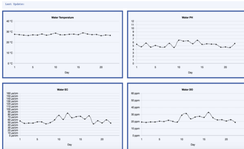
Gambar 3. Hasil pembacaan alat sensor deteksi air yaitu suhu, pH, EC dan DO hasil pembacaan
