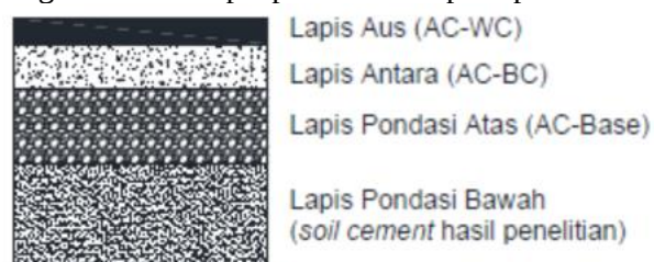
Gambar 2 Ilustrasi Lapisan Perkerasan Lentur di atas soil cement
