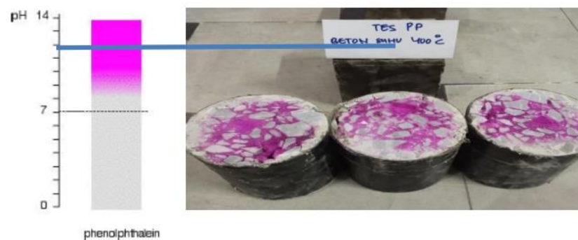
Gambar 6. Hasil Pengujian Phenolphthalein beton fc'20 setelah dilakukan pembakaran suhu 400°C
