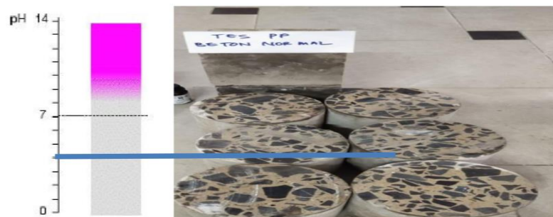
Gambar 4. Hasil Pengujian Phenolphthalein beton f_c'20 sebelum dilakukan pembakaran
