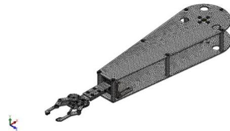
Gambar 5. Hasil *meshing* desain *arm robot*
