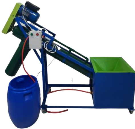
Gambar 8. Mesin Pencuci Kacang Kedelai Menggunakan Sistem Screw Conveyor
