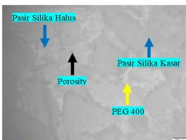
Gambar 6. Perbandingan Pasir Silika Halus 60% : Pasir Silika Kasar 20% : *Polyethylene Glycol* (PEG) 400 20%
