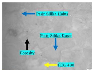
Gambar 4. Perbandingan Pasir Silika Halus 40% : Pasir Silika Kasar 40% : *Polyethylene Glycol* (PEG) 400 20%
