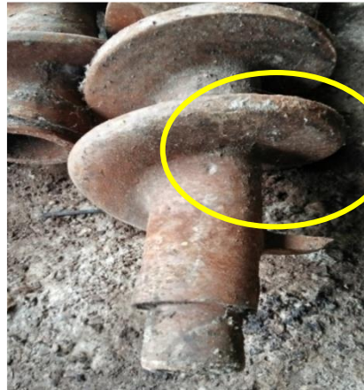
Gambar 2 Kerusakan pada worm screw press .
