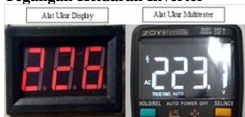
Gambar 19. Perbandingan tegangan keluaran inverter
