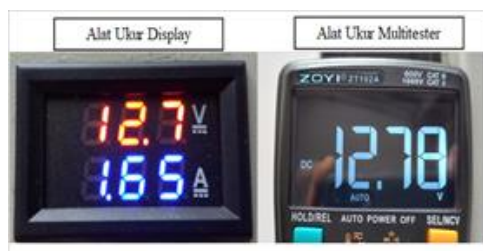
Gambar 17. Perbandingan tegangan masukan inverter
