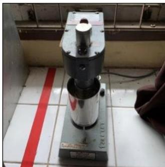
Fig. 9. Sample Experiment Using Fann VG Meter
