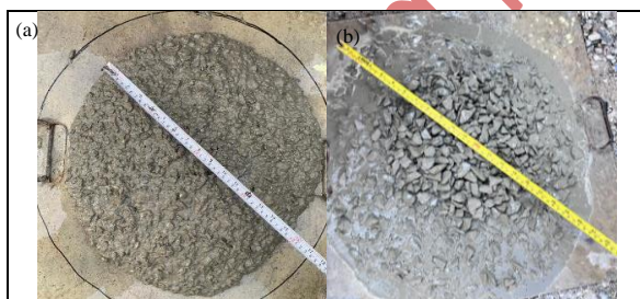
Fig. 5. Slump flow test (a) W/C 0.45 (b) W/C 0.54
