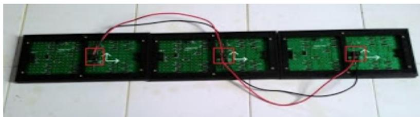
Gambar 5. Rangkaian alat *running text*
